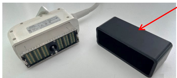
Εικόνα 32: Κάλυμμα συνδέσμου ηχοβολέα που ασφαρίζει
