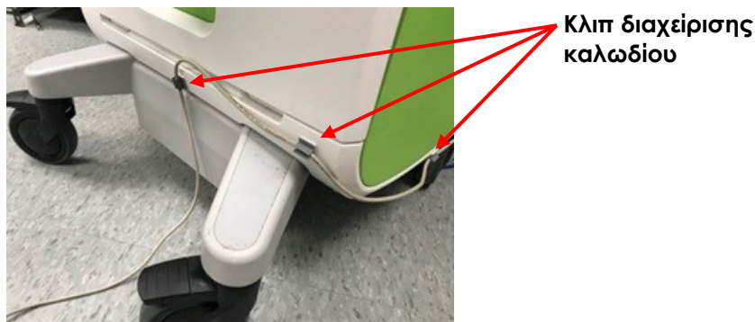
Εικόνα 4: Διαχείριση καλωδίου ποδοδιακόπτη
